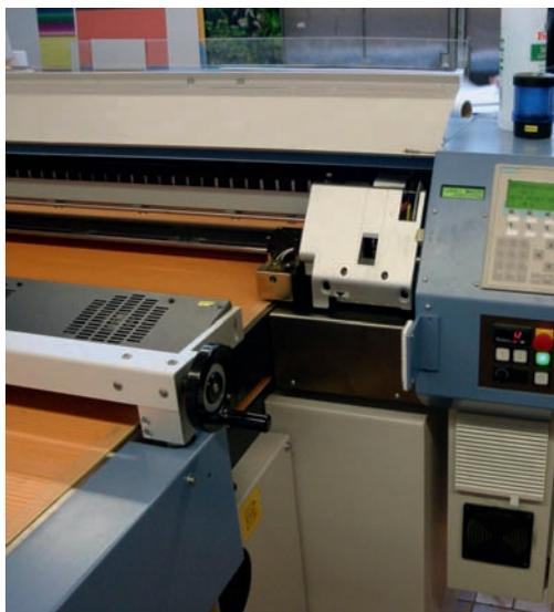
Abbildung 1: Digitaldruckmaschine zum Bedrucken von Kunststoffplatten.
