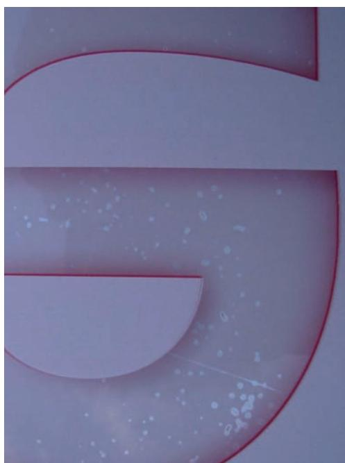
Abbildung 2: Deutlich erkennbar sind hier Farbpasserfehler beim Digitaldruck.
